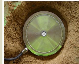
Foto 12. Útil de instalación de los sensores de deformación vertical LVDT
