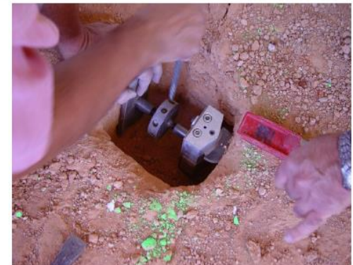
Foto 12. Útil de instalación de los sensores de deformación vertical LVDT
