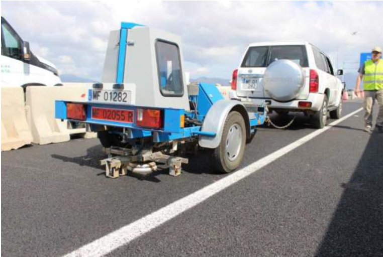
Foto 3.1. Medida con el deflectómetro de impacto en la Sección 2
